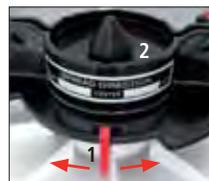
Регулировка направления разбрасывания (1), мешалка (2)
